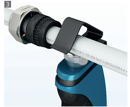
3 シールドケーブルの被覆を剥く。
